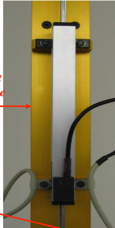
*Capteur de force à pont de jauge*
