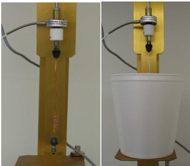
h) pour chaque matériau, mesurez **les forces critiques  $f_c$  de limite élastique** pour les courbes de traction à l'ambiante et à l'azote, ainsi les forces critiques obtenues après être redescendu à force nulle, et comparez-les. Qu'observe-t-on ? (effet de T, effet du matériau, effet de durcissement, etc.)
